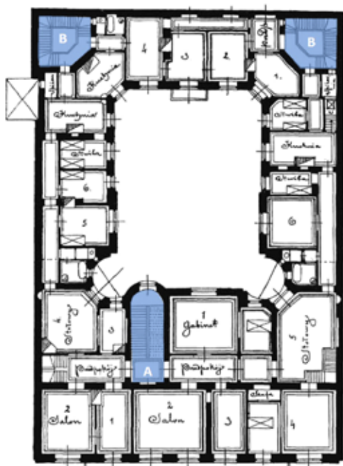
Ilustracja nr 33. Rzadko spotykany w Polsce przykład zastosowania wewnętrznych, narożnikowych, pomocniczych klatek schodowych z oświetleniem górnym (B) Schody reprezentacyjne (A) usytuowane centralnie w budynku głównym, oświetlane z boku. Warszawa, początek XX wieku.
